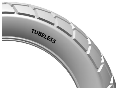
Marcado típico de los neumáticos: neumático sin cámara
