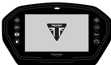
**Pantalla de instrumentos TFT: pantalla de 5 pulgadas (12,7 cm)**
