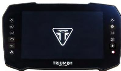
**Pantalla de instrumentos TFT: pantalla de 7 pulgadas (17,8 cm)**
