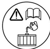
Para garantizar una refrigeración eficaz del motor, compruebe el nivel del líquido refrigerante cada día antes de utilizar la motocicleta, y rellene el depósito si el nivel de refrigerante es demasiado bajo.
