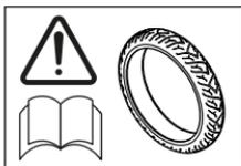
Este modelo está equipado con neumáticos, válvulas y llantas sin cámara. Utilice únicamente neumáticos con la inscripción 'TUBELESS' (sin cámara) y válvulas sin cámara sobre llantas etiquetadas como 'SUITABLE FOR TUBELESS TYRES' (Apta para neumáticos sin cámara).
