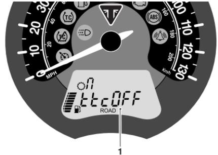
1. Pantalla de desactivación del control de tracción
